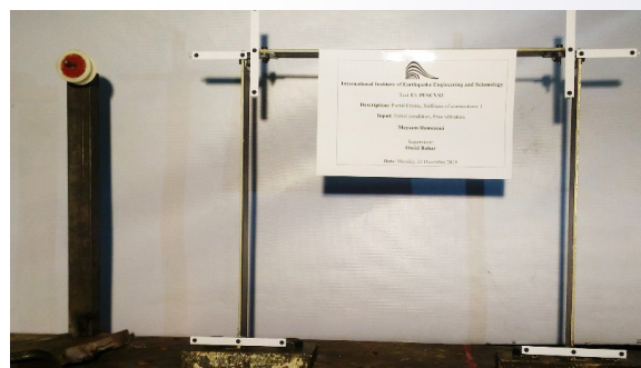
شکل (۷): مدل آزمایشگاهی قاب یک طبقه و یک دهانه
